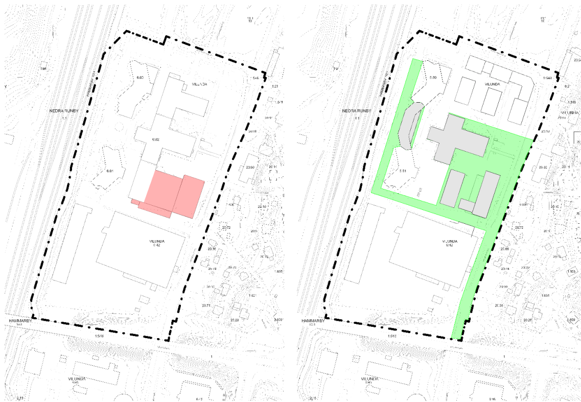
Figur 50. Röd markering visar vad som ska rivas under etapp två och grön markering visar område där byggnation kommer att pågå under etapp två.
