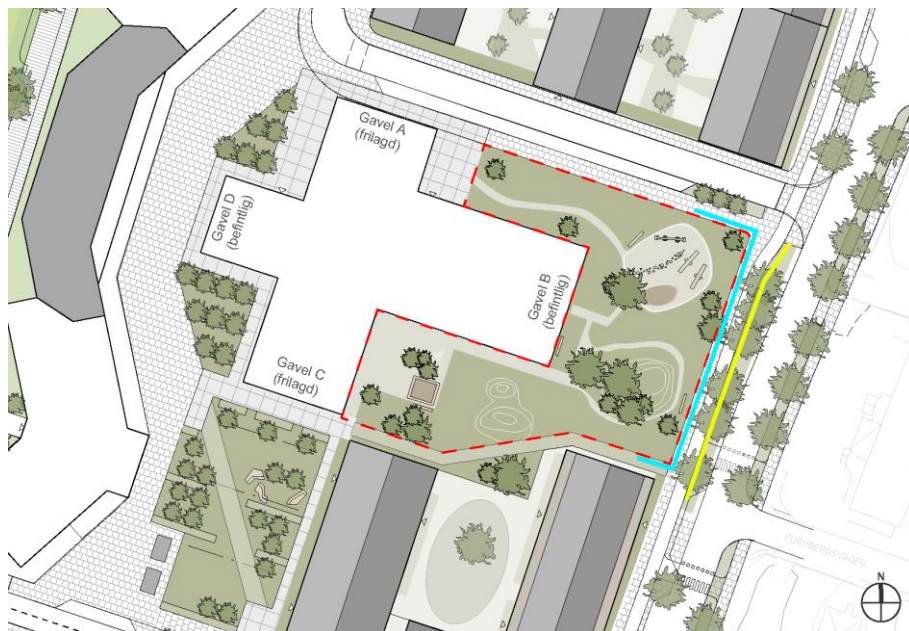
Figur 33. Röd streckad linje visar förskolegårdens avgränsning. Blå linje visar bullerskärmen utmed förskolegårdens gräns och gul linje visar bullerskyddets placering utmed Optimusvägen.
