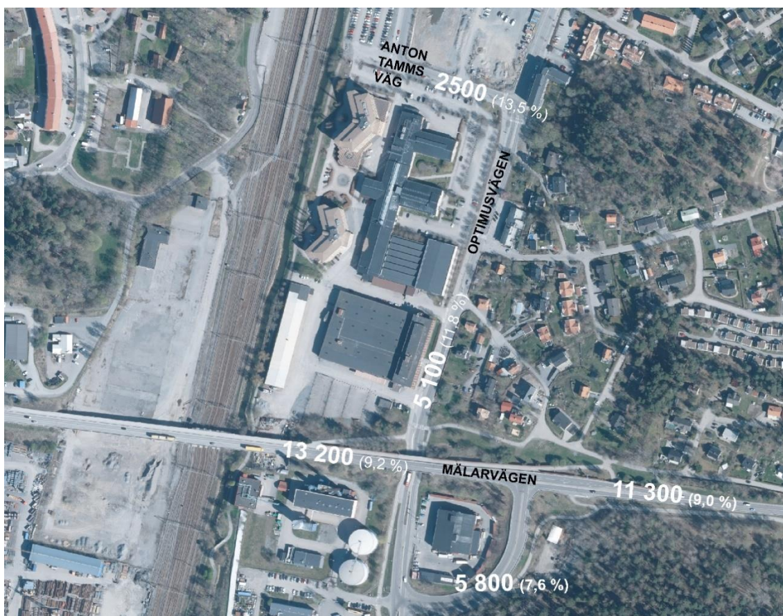
Figur 58. Kartan visar trafikmängder per dygn år 2023. Andel tung trafik visas inom parentes.
