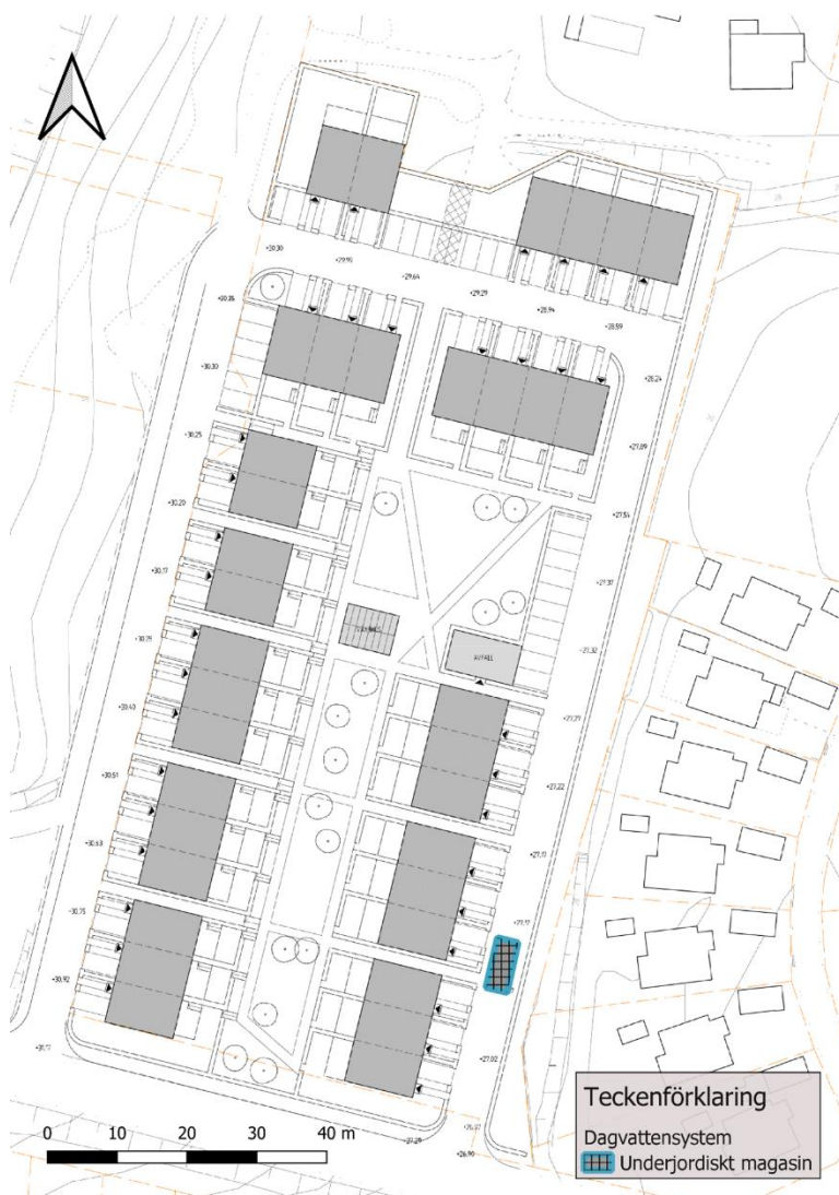
Figur 7-1. Schematisk skiss av föreslagen dagvattenhantering på allmän platsmark med ett underjordiskt dagvattenmagasin.
